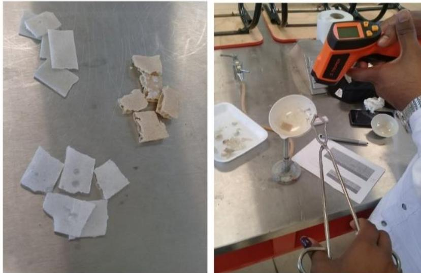
Prueba térmica para mostrar punto de fusión de las resinas combinadas.
